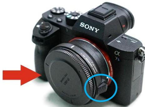
轉接環若非必要請勿任意拆卸，上圖藍圈處為轉接環和鏡頭的拆卸卡榫，請從此處拆卸鏡頭即可。
