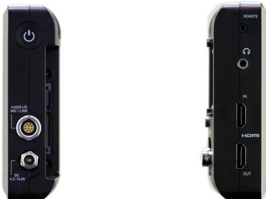
機身右側從上到下依次為 1.開機電源鍵 2.miniXLR input端口 3.DC電源連接端口
