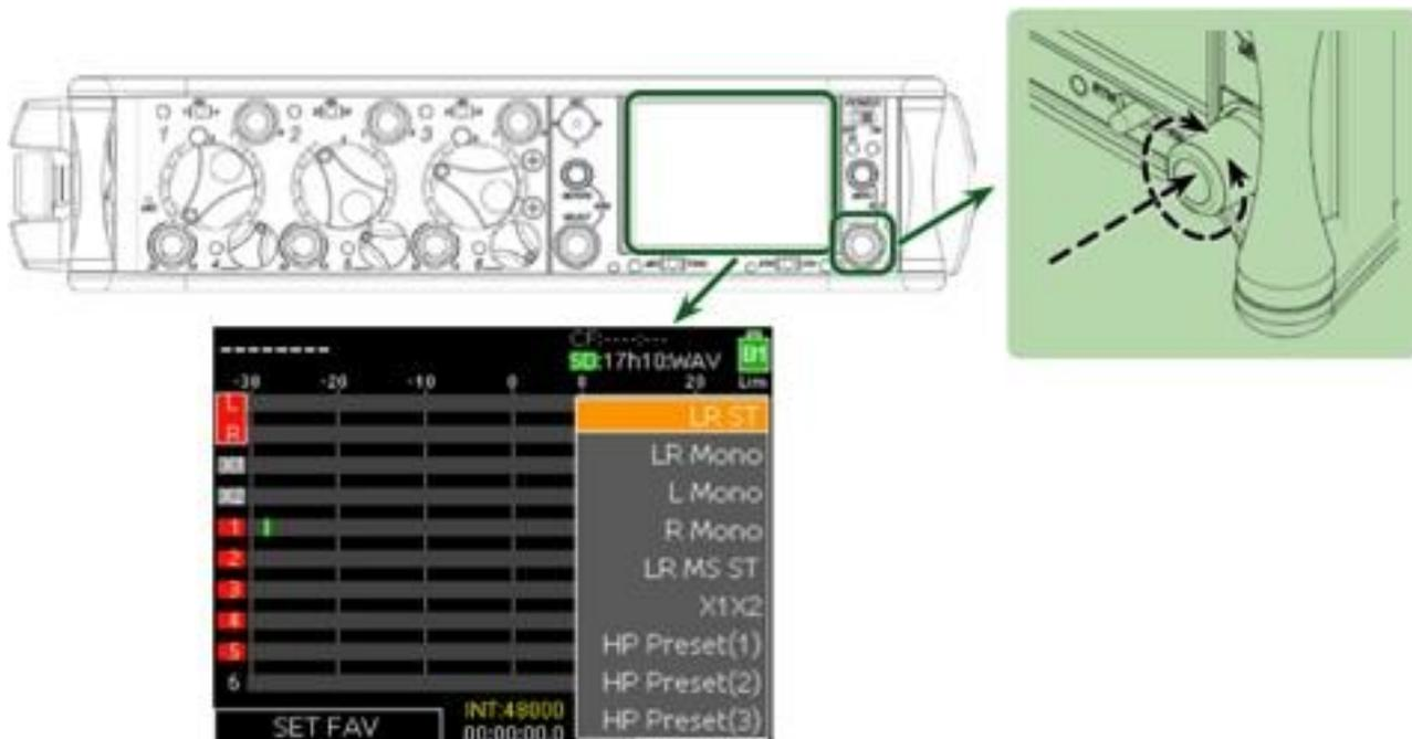
CF卡槽、SD卡槽以磁力吸附艙門，裝設或取出記憶卡時，請稍微用力拉開艙門再進行裝/取卡動作
