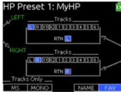
選擇把哪些軌送到監聽耳機左/右耳進行監聽動作，兩耳可以送不同的input 可以自行設定多組不同的耳機路徑
