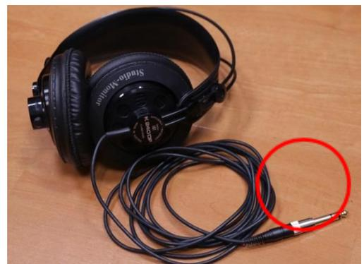
(圖五) PHONE頭已接在耳機上。
