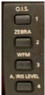
此區域為自定義按鍵，默認設置為防抖控制 (O.I.S) 斑馬紋 (ZEBRA) 波形圖 (WFM) 以及自動電子光圈 (A.IRIS LEVEL)
