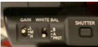
此區域為操作gain值以及白平衡，快門的區域，可在SW MODE中調整其每個檔位之數值
