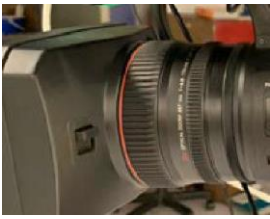
三個鏡頭控制環，從左到右依次為對焦，變焦以及光圈環
