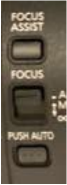
此區域為對焦輔助區，從上至下分別為對焦輔助(Peaking)，切換自動，手動，無限遠的快捷鍵以及按一下即可自動對焦的FOCUS PUSH AUTO按鍵
