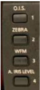
此區域為自定義按鍵，默認設置為防抖控制 ( O.I.S ) 斑馬紋 ( ZEBRA ) 波形圖 ( WFM ) 以及自動電子光圈 ( A.IRISLEVEL )
