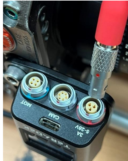
接收器電源線連接(新版 3pin)
