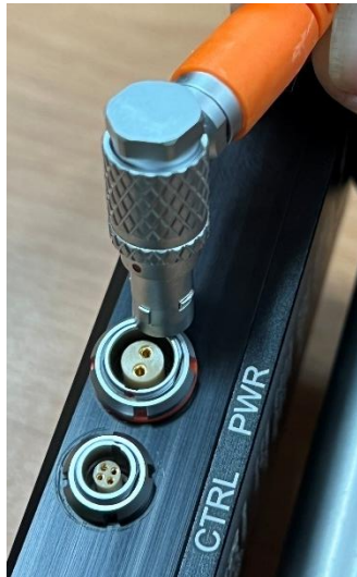
接收器電源線連接(舊版 2pin)
