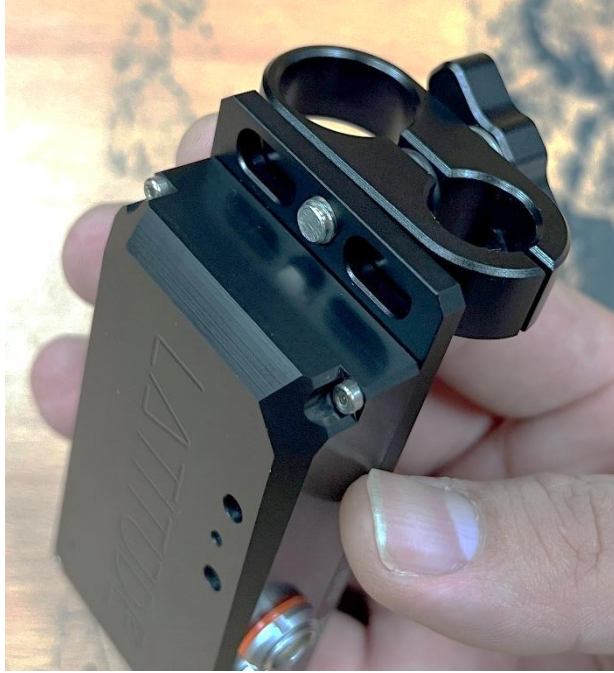
將接收器管夾從後方鎖上(舊版)
